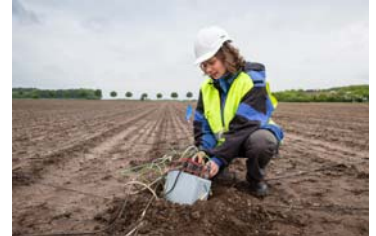
Die Empfängerstationen erfassen elektromagnetische Felder im Untergrund – die Daten geben Auskunft über das vorhandene Erdöl in der Lagerstätte.
