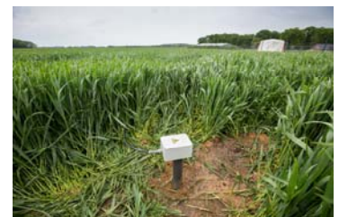
Isolierte Elektroden leiten den Wechselstrom in den Boden und erzeugen so elektromagnetische Felder im Untergrund.
