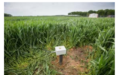
Die Elektroden leiten den Wechselstrom in den Boden und erzeugen so elektromagnetische Felder im Untergrund.
